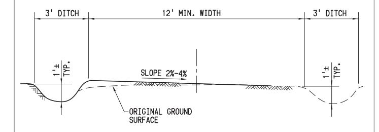
TYPICAL FLAT SECTION (20% MAX. EXISTING GROUND SLOPE)
